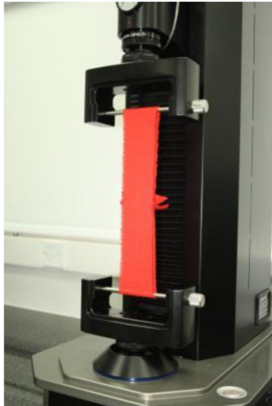
Mẫu được găng và kéo bằng ngàm Loop Bar T18
